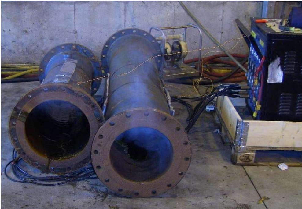
Figur 1 - Varme/temperatur testing, PV-100 til venstre, alternative voks til høyre
