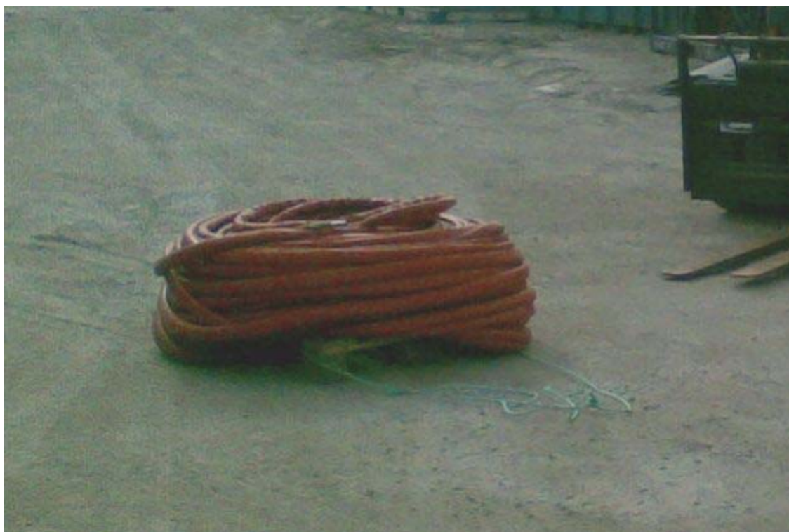
Figur 5 - 2 x 200 m voks- & luftslangearrangement på palle klargjort for vinsj trekketest
