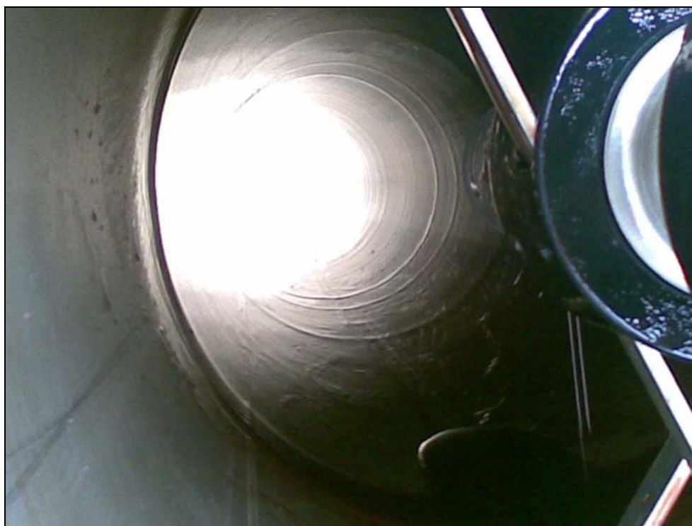
Figur 9 - Vokseresultat i 16" rør.
