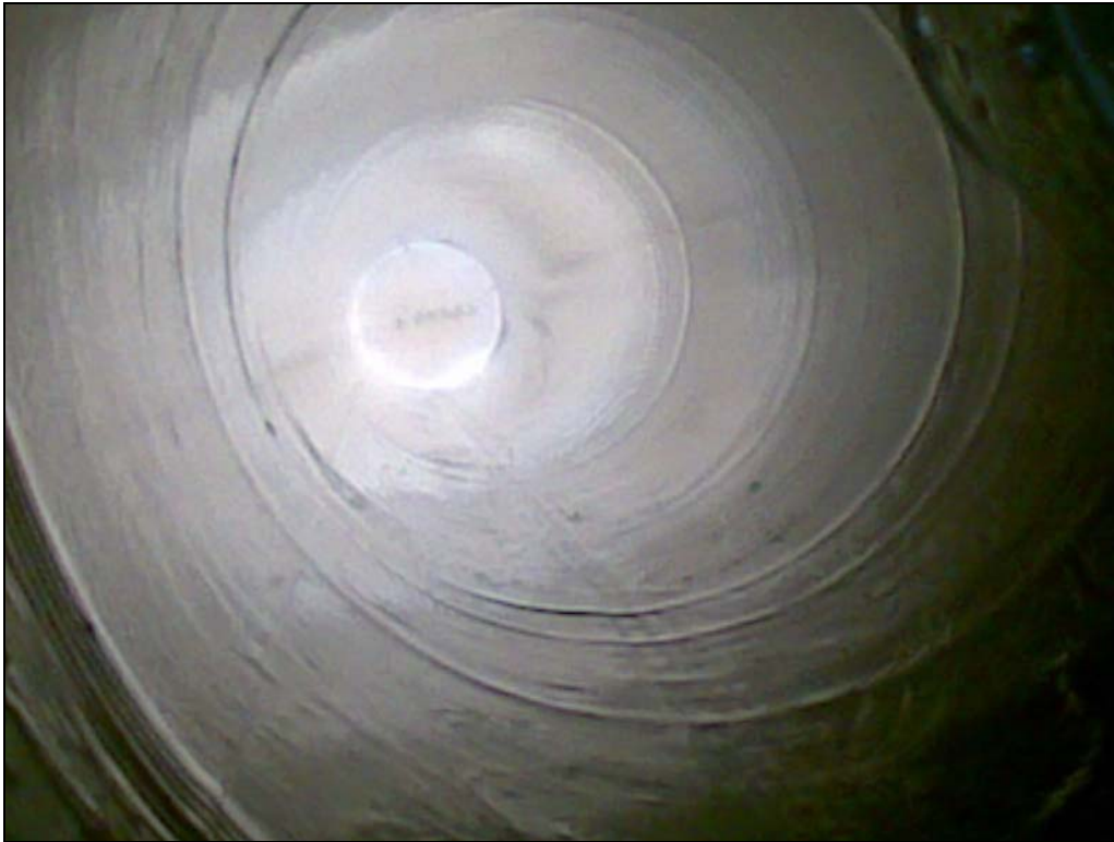
Figur 10 - Vokseresultat i 16" rør, tykkelse 125-150 \mu\text{m} (krav 75 \mu\text{m} )
